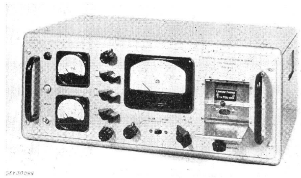
Fig. 3 Appareil pour la mesure du souffle des transistors
