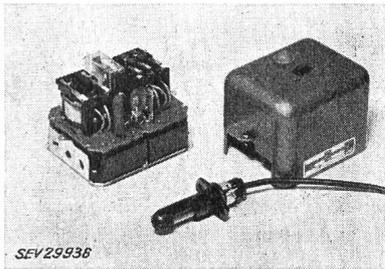
clenchement. Liaison par broches entre la plaque de base et le châssis. Alimentation sans transformateur de réseau. Vis de mise à la terre. Cellule photoélectrique logée dans un boîtier séparé, avec amenée de courant de 1,2 m.
