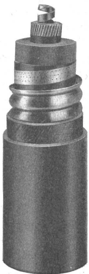
Fig. 1 Câble à huile sous gaine ondulée de cuivre 150 kV, 1 x 300 mm 2
