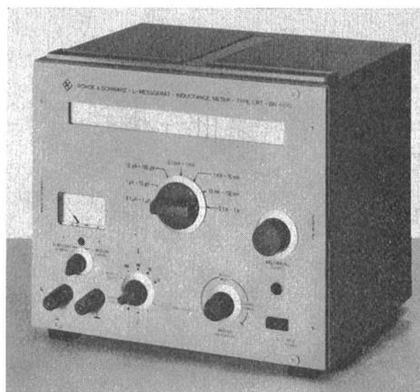
auch Gütefaktoren von 2...1000 (für  $L \geq 1 \mu\text{H}$ ) direkt an. Auf einfache Weise lassen sich auch Eigenkapazitäten von Spulen zwischen 0 und 200 pF ( $Q > 20$ ,  $L > 42 \mu\text{H}$ ) und die Resonanzfrequenz von Parallelschwingkreisen erfassen sowie sehr genaue L-Vergleichsmessungen durchführen.
