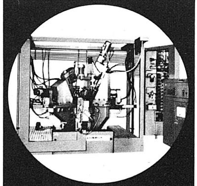
Unités d'usinage de précision à commande hydraulique et hydro-pneumatique; Opérations: perçage (aussi en déburrage), alésage, taraudage et filetage, planage et tournage. Machines de production à une ou plusieurs stations. Machines transfert linéaires, circulaires (aussi avec tables satellites), rotatives et exécution spéciales.
