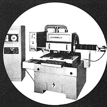
Machines multibroches automatiques de haute performance à commande CNC pour le perçage et le contourage des circuits imprimés. Machine de programmation et de mesure de haute précision. Machines à percer et à fraiser pour petites séries, prototypes et fonctions annexes.
