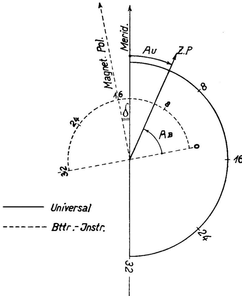
Zwischen dieser Richtung und der Nadel besteht der Richtungsunterschied  $\delta$ , die Deklination, deren Bestimmung nach der Karte am folgenden Beispiel gezeigt werden soll.
