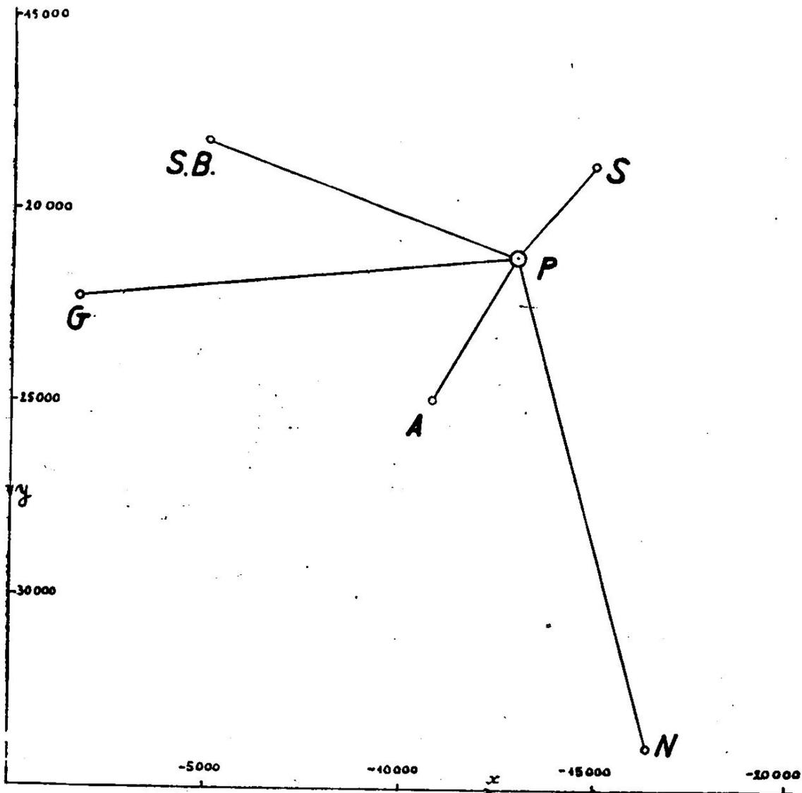
bekannt sind. Für jeden Strahl ist sodann die Differenz der Coordinaten  $x$  und  $y$  seiner Endpunkte zu rechnen:  $\Delta x$  und  $\Delta y$ , womit die Richtung des Strahles gegeben ist:
