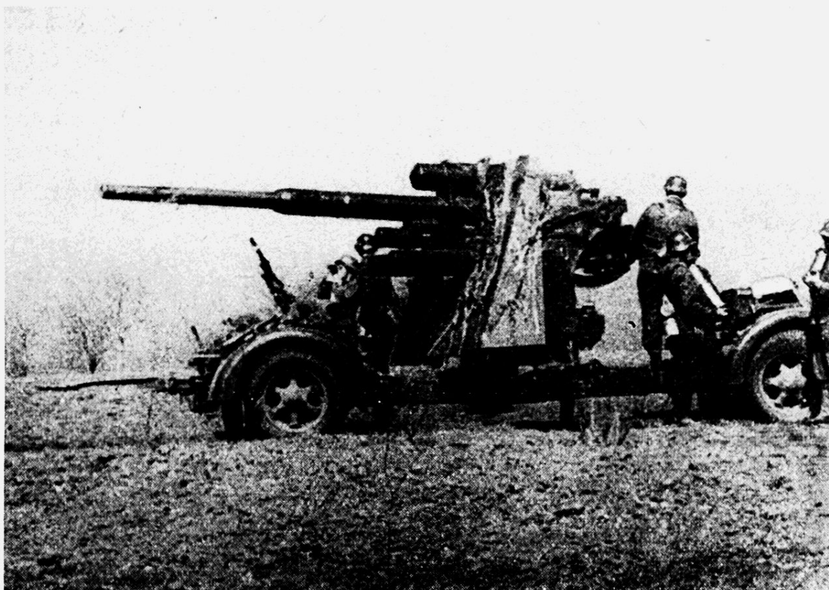
Abbildung 1. Deutsche 8,8 cm Flak mit Kreuzlafette und Panzerschutzschild. Das Geschütz ist auch mit den Fahrgestellen behelfsmässig feuerbereit.
