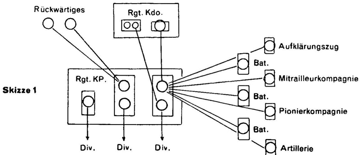
Die Drahtverbindungen erlauben sowohl Telephonie wie auch Telegraphie. Für den Bau und Unterhalt der Linien sind drei Gruppen zu je drei bis vier Mann verantwortlich. Diese verfügen über je einen Jeep mit Anhänger und 10 km Gefechtskabel sowie 23 km Feldkabel. (Skizze 2)
