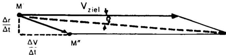
Fig. 4. Vektorielle Addition der Vorhaltestrecke und der Vorhaltefehler
