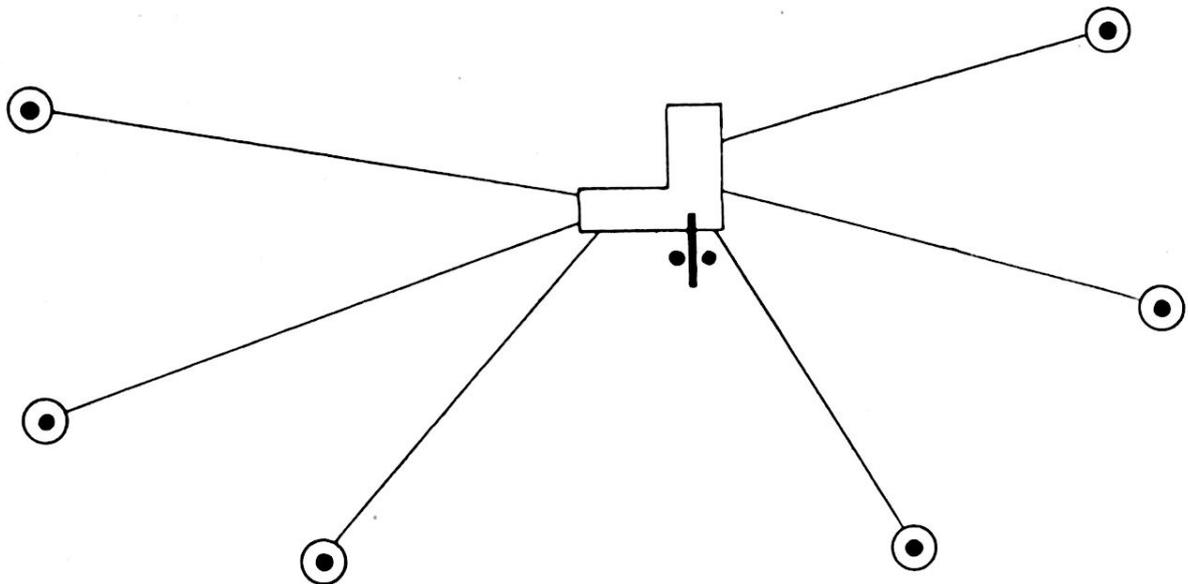
Wichtige Waffennester werden durch ausgelegte Zugminen, die durch Schnurzug vom Deckungsloch aus unter die Gleisketten gezogen werden, gesichert. (Skizze 4. Minen mit Kufen aus Holzlatten oder Bandblech versehen, damit sie nicht an Bodenunebenheiten hängen bleiben!)
