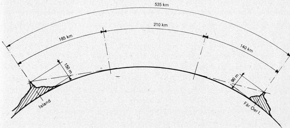
Fig. 9. Streckenprofil Island - Fär Oer
