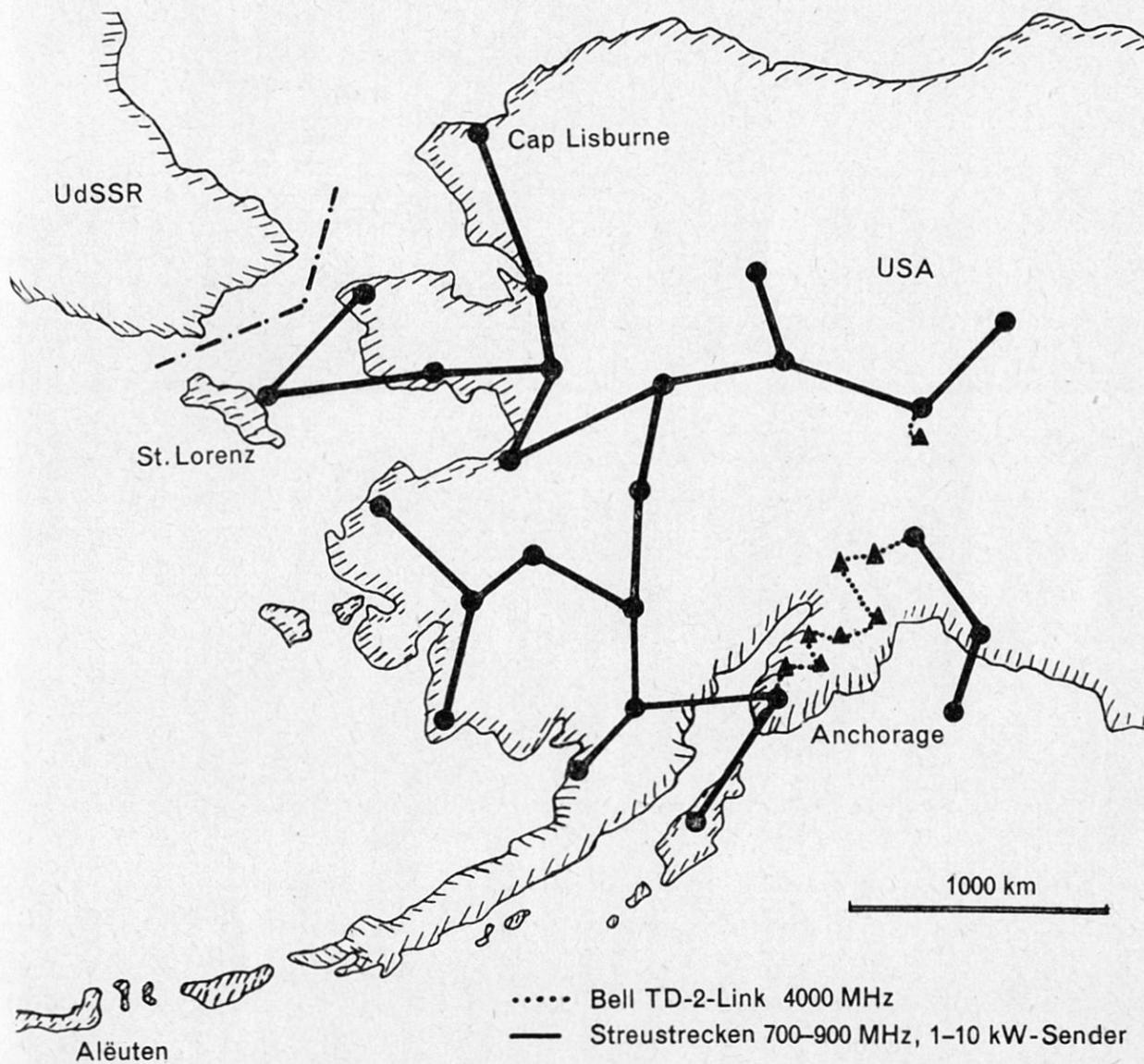
Fig. 6 «White-Alice»-Streustrahl-Verbindungssystem in Alaska.
