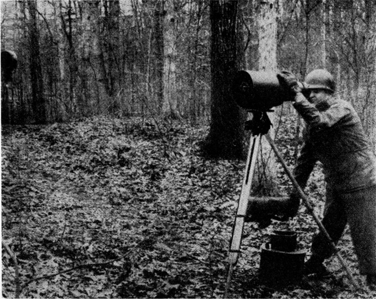
Fig. 5. Ein Beobachtungsgerät für den Bat.Kdt., das mit Infrarot arbeitet, gestattet die Nachtbeobachtung bis auf die Wirkungsdistanzen der organischen Bat.Waffen.
