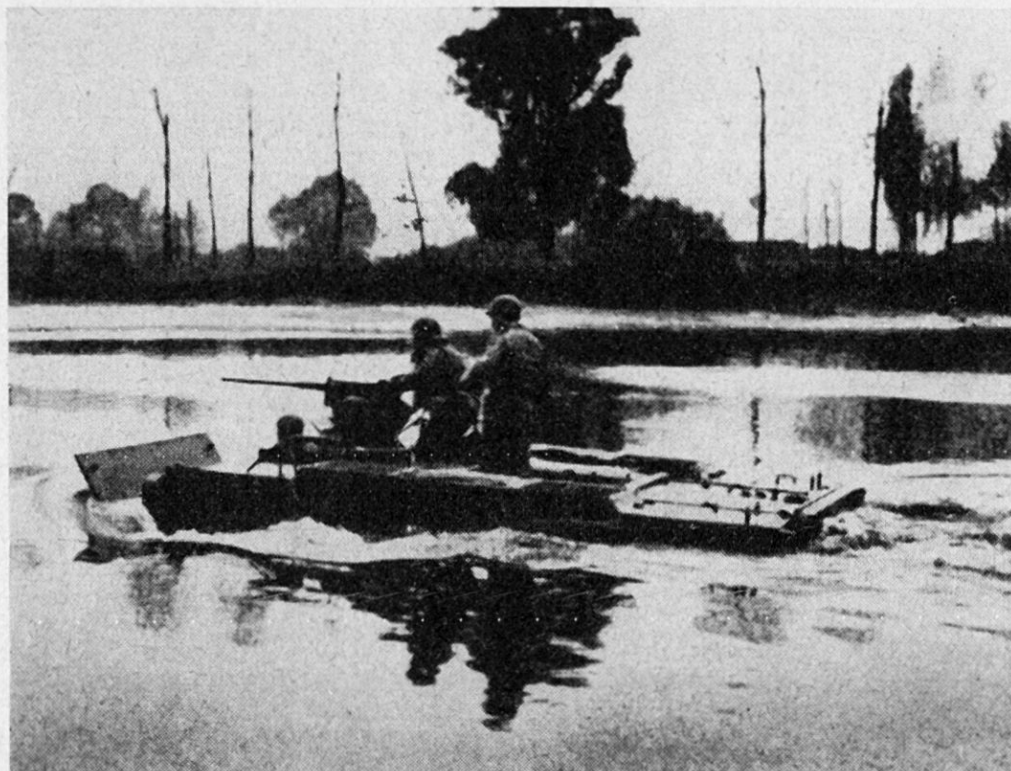
Abb. 3. Der amerikanische Schützenpanzerwagen M 59 ist schwimmfähig.
