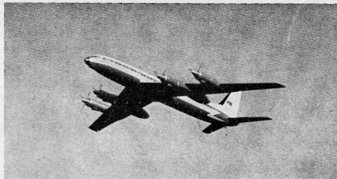
Bild 5. TU-114 «Rossiya» Transportflugzeug, das aus dem TU-20-Bombardierungsflugzeug entwickelt worden ist. Tragfähigkeit 220 Personen bei 800 km/h.
