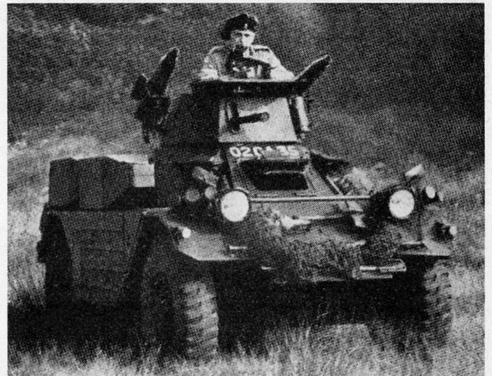
Bild 3. Panzerabwehr-Lenk Waffe «Vigilant» für Panzerspäherwagen
