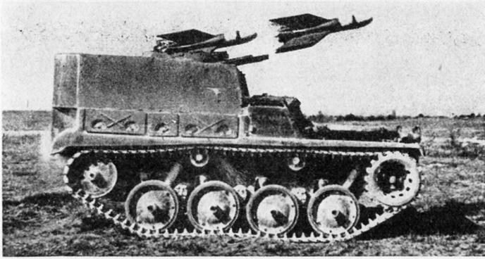
Bild 2. Hotchkiss-Selbstfahr-Werfer mit 4 Panzerabwehr-Lenk Waffen SS 11
