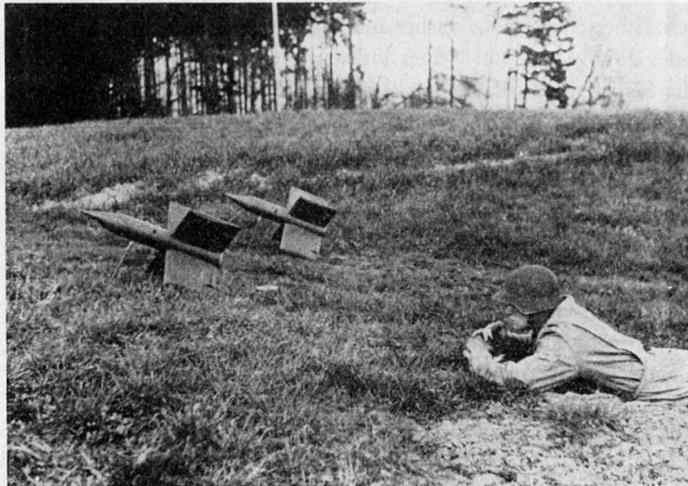
Bild 1 Panzerabwehr-Lenkwanne «Mosquito» schußbereit ab Boden (Tarnung weggelassen)
