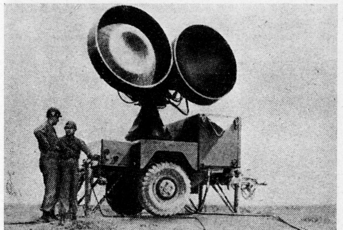
Bild 5. Beleuchtungs-Radar für die USA-Flab-Lenk Waffe «Hawk»
