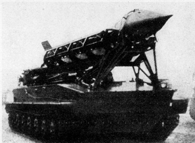
Bild 3. 25-km-Rakete BB 1 auf Panzerwerfer PT
