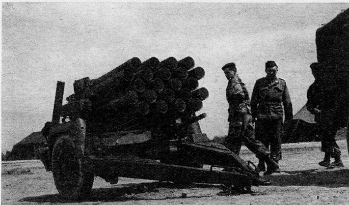
Stellungsbezug erfolgt sehr rasch; die Lafette wird durch das Absenken von zwei Spornen verankert. Der Abschluß der raketentriebenen Geschosse erfolgt einzeln in rascher Folge, so daß die 22 Geschosse in wenigen Sekunden die Waffe verlassen. Die Schußdistanz beträgt 7 bis 8 km, das Kaliber 135 mm. Durch Nachladen des Geschützes können 400 Geschosse innerhalb von 4 Minuten auf einem Geländeabschnitt von 4 Hektaren verschossen werden.
