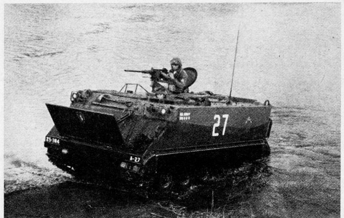
Bild 1. Der amerikanische Standard-Schützenpanzer M 113, bewaffnet mit einem überschweren Maschinengewehr. Der Mannschaftsraum ist vollständig geschlossen
