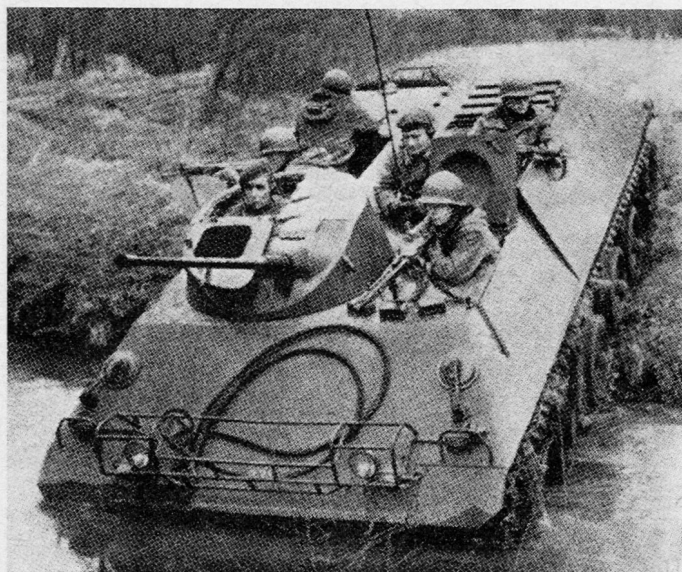
Bild 3. Der Schützenpanzer HS-30 der deutschen Armee. Die Lücken im Dach sind gleichzeitig Ausstiegsöffnungen für die Besatzung an Stelle der Hecktüre
