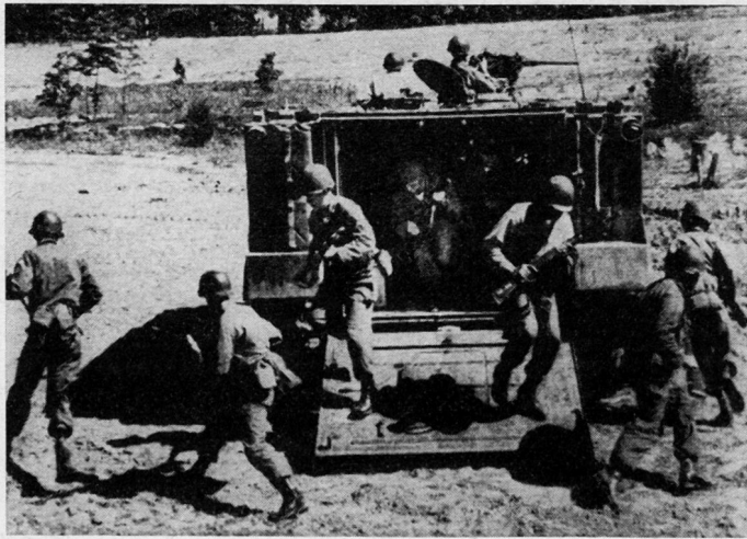
Bild 2. Die transportierte Mannschaft kann innert weniger Sekunden durch die Hecktüre das Fahrzeug verlassen, um in das Fußgefecht überzugehen
