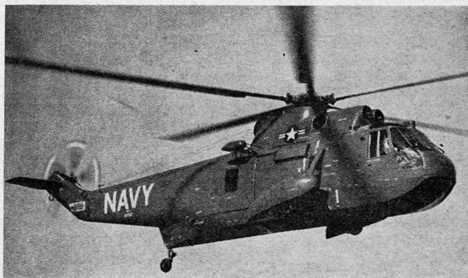
Bild 17. Sikorsky HSS-2 mit 2 Gasturbinen zu je 1050 PS Die Maschine wiegt maximal 8 Tonnen und kann bis 2,2 Tonnen Last mitnehmen. Rotordurchmesser 19 m
