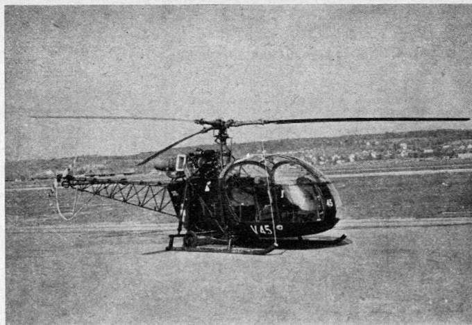
Bild 16. Die Alouette III. Maximal 5 Passagierplätze Ein Triebwerk Alouette II von 400 PS Maximales Startgewicht 1500–1600 kg. Rotordurchmesser 10,2 m
