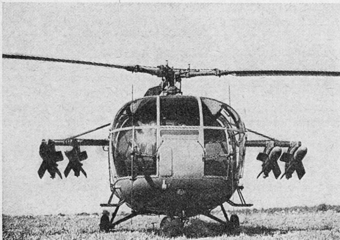
Bild 8. Alouette III mit Panzerabwehrraketen SS-11
