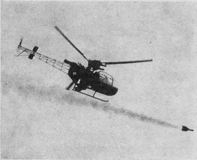
Bild 2. Alouette II, Abschub einer Panzerabwehrrakete SS-11
