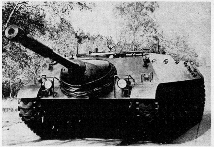
Bild 5. Der Kanonenjagdpanzer der deutschen Bundeswehr mit einer Kanone 9 cm mit großer V°. Das Fahrzeug ist sehr schnell und beweglich
