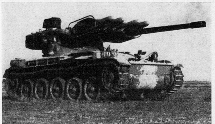
Bild 6. Kombination von Geschütz und Rakete durch Aufbau von Abschlußbrämen für die Rakete SS 11 auf dem leichten Panzer AMX 13
