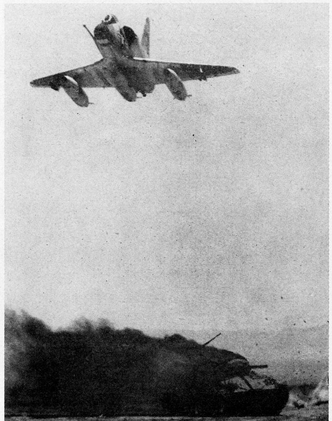
Bild 4. Am A4 «Skyhawk», der hier das zerstörte Ziel überfliegt, sind deutlich die drei aufgehängten «Mark IV» ersichtlich.
