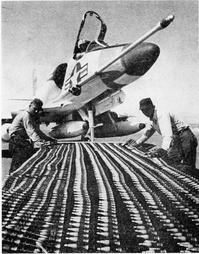
Bild 1. A4 «Skyhawk» mit drei montierten «Mark-IV»-Kanonenbehältern und derjenigen Menge von Geschossen, welche einem Feuerstoß von 4 Sekunden oder rund einem Drittel der gesamten Munitionsausrüstung entspricht.
