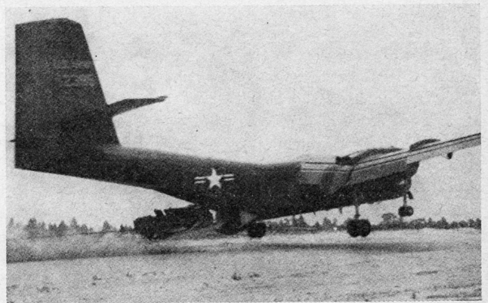
Bild 8. In der Transportgruppe ist der CV 2 «Caribou» für Transportaufgaben eingesetzt. Er kann 2,3 t oder 32 Mann transportieren. Das Bild zeigt eine neuartige Weise des Materialauslades, bei der das Transportgut auf einem Schlitten verladen und mit Hilfe eines kleinen Fallschirmes aus dem Rumpf des sehr niedrig fliegenden Flugzeuges gezogen wird.
