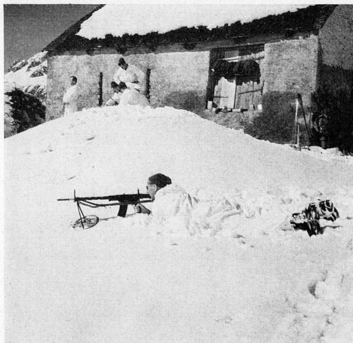
Bild 4. Standardlösung mit dem angebundenen Schneereifen. Die unschöne Neigung der Vorderstützen ist bedingt durch die relativ starre Verbindung der Stützenspitzen mit dem Schneereif sowie das Einsinken der Ellbogen in den Schnee.
