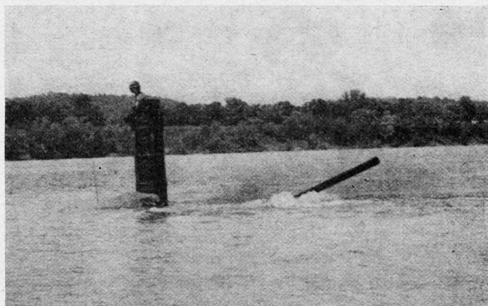
Bild 2. M60 während einer Unterwasserfahrt.
