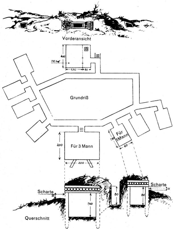
Bild 8. Einfacher russischer Stützpunkt mit Maschinengewehr- und Schützennestern.
