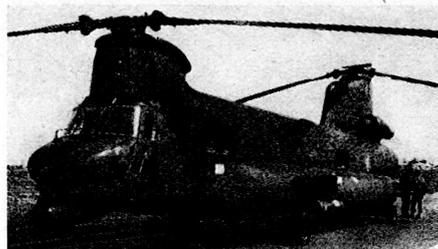
Bild 1. Seitliche Ansicht der Chinook CH-47, mit gut sichtbaren Waffenständen. Granatwerfer am Bug, 2 Mg. Stände auf jeder Rumpfseite, Kanone und Raketenwerfer seitlich außerhalb des Rumpfes.
