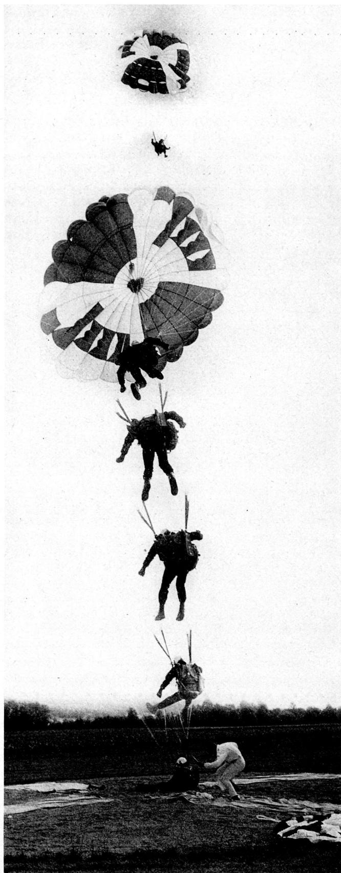
Bild 2. Photomontage einer Ziellandung. In ihrer letzten Phase stellt sich der Springer gegen den Wind. Man beachte die «Steuerschlitze», welche dem sinkenden Schirm eine gewisse Vorwärtsbewegung verleihen. (Photo Comet)
