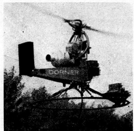
triebe, Freilauf, Wellen und Heckrotor konstruieren. Das Fahrzeug kann mit jeder Art von Betriebsstoff in Gang gebracht werden. Bei entsprechender Ausrüstung eignet sich die «Drone» vor allem für die Gefechtsfeldaufklärung. bb
