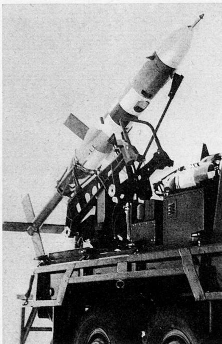
Im Aufbau ist das Gerät so konstruiert, daß es vielfach verwendet werden kann; eine Erneuerung ist nur bei den Schubelementen notwendig. Jede Kamera erhält etwa 30 m Film und kehrt so bestückt etwa mit tausend Aufnahmen zurück. Dieses technische Wunderwerk ist selbstverständlich entsprechend der Anforderung ausgerüstet, um Stereo-, Vertikal- und Schrägphotos schießen zu können. Seine Truppenversuche bestand es ausgezeichnet.
