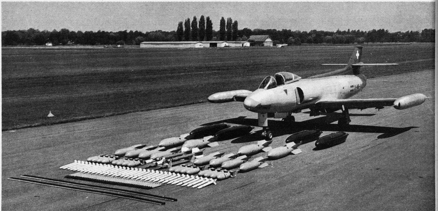
Bild 1: Erdkampfflugzeug P 16 Mk. III mit der Außenlastkonfiguration der AA 7 sowie mit Munition für die HS-Kanonen und den «Matra»-Raketenautomaten (1. und 2. sowie 3. Reihe vorn links).
