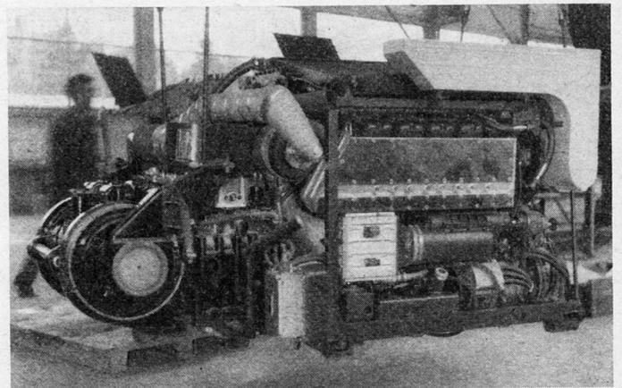
Bild 9. Antriebsgruppe vollständig in Blockbauweise.
