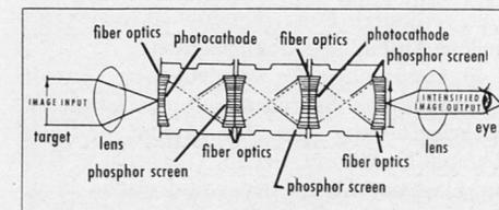
Prinzipskizze des Lichtverstärkungsgeräts. Das Ziel (target) wird von der Linse (lens) aufgenommen, das Licht sodann durch die Faseroptik (fiber optics) auf die Fotokathode geleitet. Diese sendet Elektronen in Richtung des Leuchtstoffschirms (phosphor screen), wo die Energie wieder in sichtbares Licht umgewandelt wird. Der Vorgang wiederholt sich bis zur Einblicklinse für das Auge (eye).
