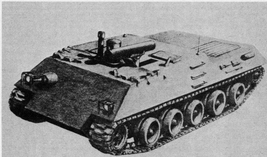
Abschußanlage für den Raketenjagdpanzer: Sie besteht aus zwei Ausfahrampen und einer Lenkanlage in periskopischer Bauweise. Das Nachladen geschieht automatisch beim Einfahren der Rampen in das Fahrzeug. Nach dem Schuß werden die leeren Abschußrohre seitlich abgeworfen. Die Rampen (Munitionshalterungen) sind in Seite und Höhe schwenkbar und werden durch eine Gleichlaufeinrichtung den Visierbewegungen nachgeführt.
