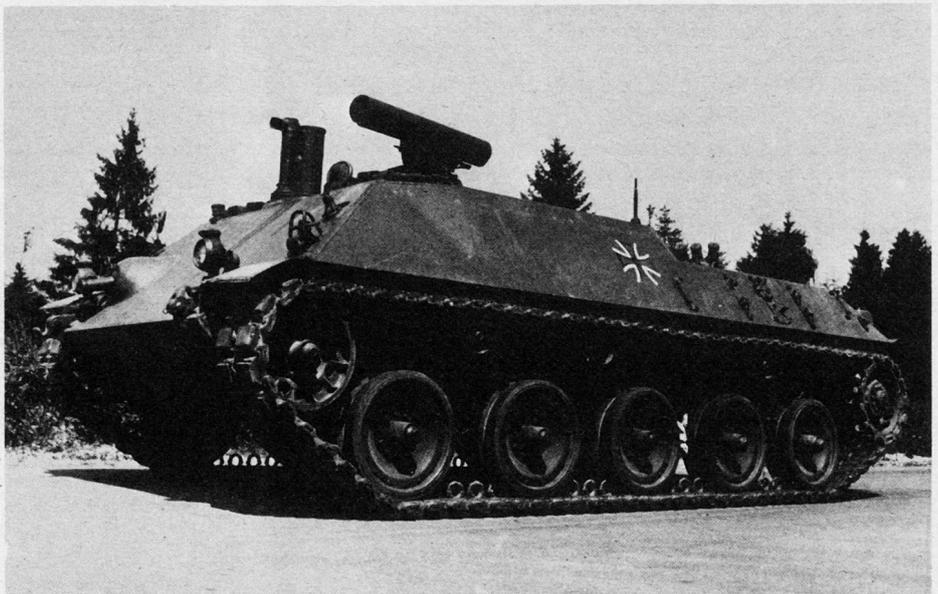
Aviation. Die «Hot» ist ein Panzerabwehrwaffensystem großer Reichweite mit halbautomatischer Lenkung und kann auf jedes Rad- oder Kettenfahrzeug aufgerüstet werden, das über eine Lukenöffnung mit einem Durchmesser von etwa 800 mm verfügt. Wa
