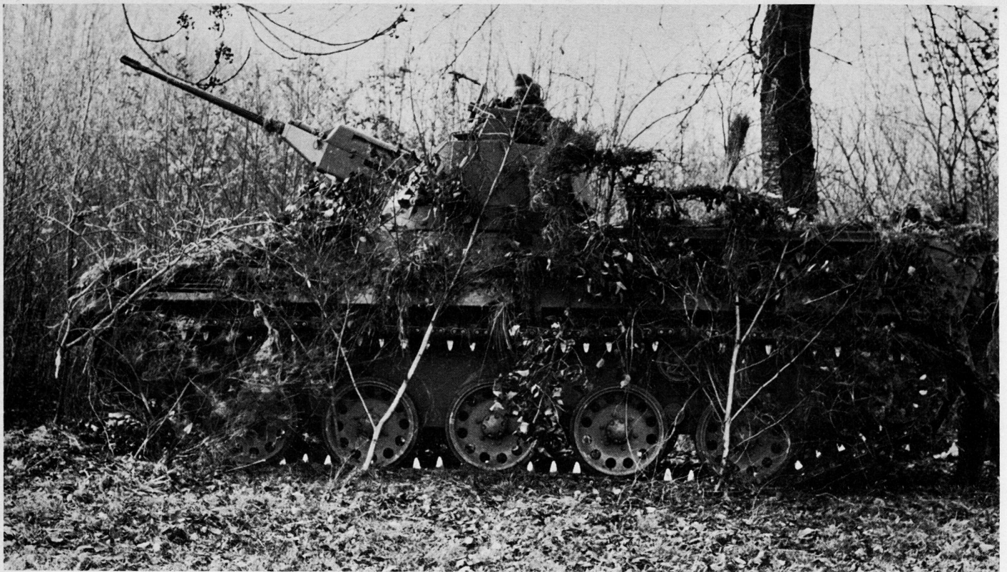
Bild 5. Schützenpanzer Saurer mit 20 mm Mk, Gewicht 12,5 t, 1 + 9 Mann, 250 PS Diesel, Geschwindigkeit 60 km/h, 350 km auf Straße,
