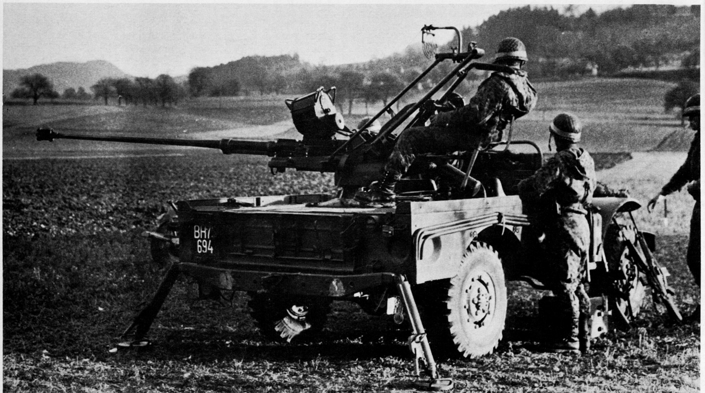
Bild 7. FLAMK 20 mm M 58 auf Dodge-Chassis montiert, 2-cm-Oerlikon-Flak 58.
