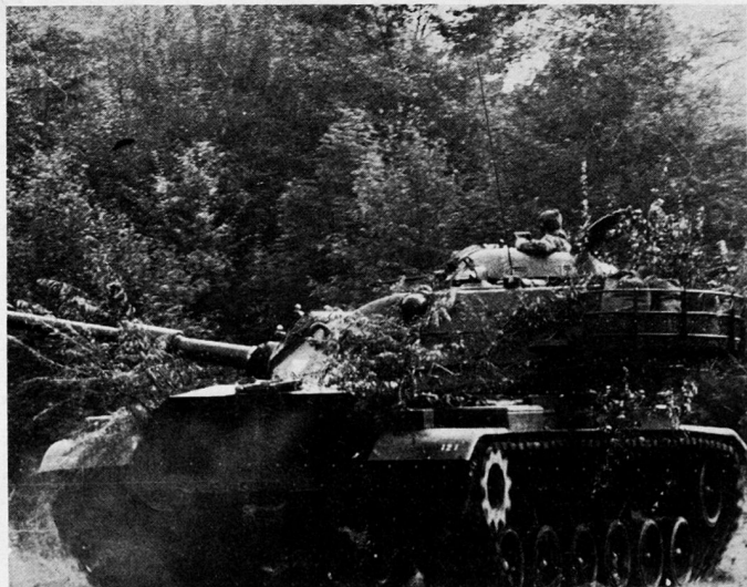
Bild 1. M 60 A1-Panzer im Gefecht. 105 mm PzK L/51, V_0 1450 m/sec, 1 Mg, 1 FlabMg-Turm 12,7 mm.
