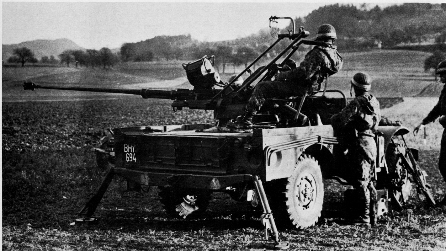
Bild 7. FLAMK 20 mm M 58 auf Dodge-Chassis montiert, 2-cm-Oerlikon-Flak 58.
