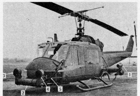
Bild 1. Bell «Iroquois» mit dem INFANT-System. (1) Xenon-Suchlichter, (2) Spezial-Bugdrehturm für INFANT, (3) Nachtsichtgerät, (4) direktes Bildverstärkungsvisier, (5) Faseroptikkabel.
