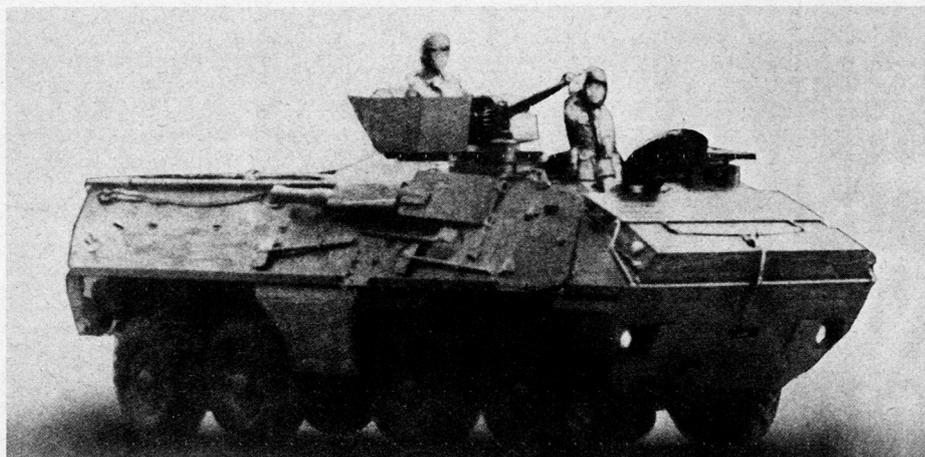
Bild 1. OT 64 mit 12,7-mm-Maschinengewehr im Drehturm.
