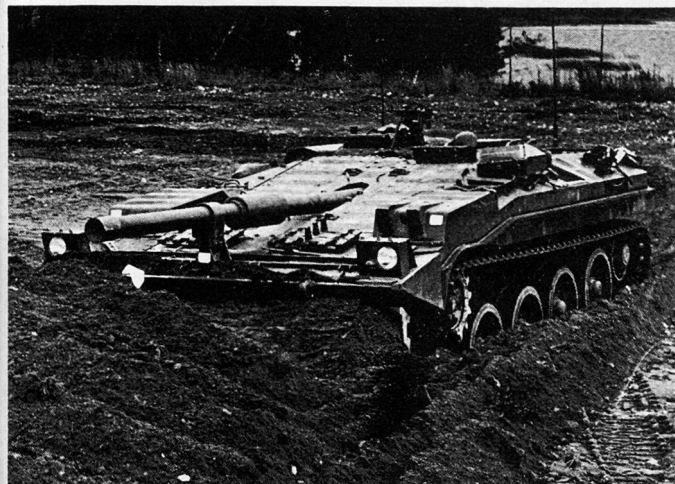
Bild 3. KPz Strv 103 mit Räumschaukel beim Eingraben.
