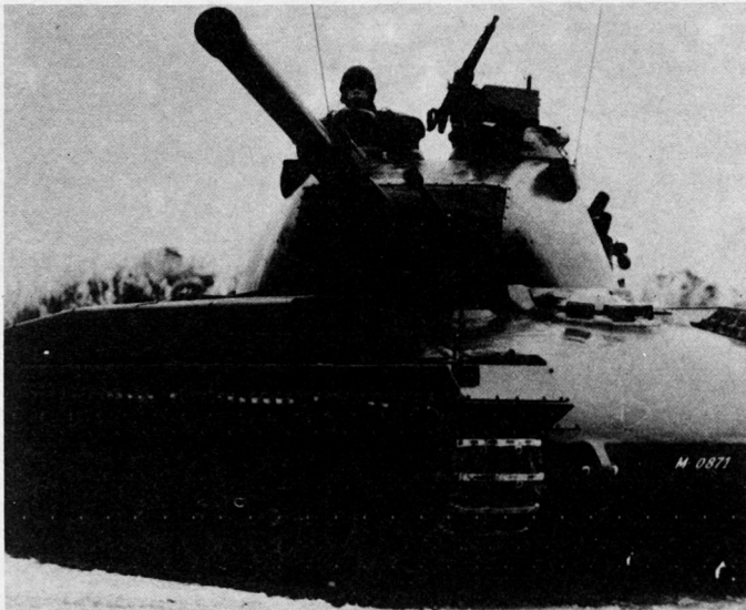
Bild 10. Waffen, die der Gegner aus Distanz erkennen kann – und er sieht gut (Feldstecher, Geschützoptik) –, kommen nicht zum Schuß. Sie werden vor Beginn des Angriffs durch Panzerkanonen herausgeschossen. Das Feuer dieser großen Kaliber (10 bis 12 cm) ist auf Distanzen bis 1000 m ebenso präzise wie ein Zielfernrohrgewehr: Was man sehen kann, wird auch getroffen! Bild oben: Panzerkommandant beobachtet mit dem Feldstecher aus der geöffneten Turmluke. Bild unten: Die Besatzung eines russischen Kampfpanzers T 54 wird ins Kampfgebiet eingewiesen.
