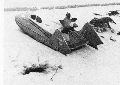
260-PS-Fünfcylinder-Flugzeugsternmotor. Die Lenkung erfolgt mit Hilfe zweier Seitenruder. Dieses Fahrzeug kann fünf Passagiere oder eine Nutzlast von 650 kg transportieren. Im Schnee entwickelt es eine maximale Geschwindigkeit von mehr als 120 km/h. ob
