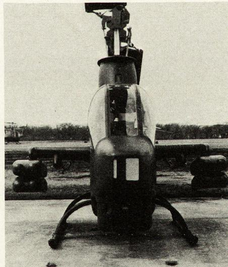
Dieser Kampfhelikopter wird mit Panzerabwehrlenk Waffen vom System TOW ausgerüstet. Die TOW gibt der Huey «Cobra» eine außerordentlich hohe Waffenwirkung gegen stark befestigte Ziele und gegen Panzerfahrzeuge auf Distanzen bis zu 3000 m. Die Lenk Waffen sind in Zweierbehältern an der äußeren Waffenstation des Flügelstummels aufgehängt. Das Bild zeigt eine Maquette dieses Helikopters mit je vier Lenk Waffen pro Seite. Kg.
