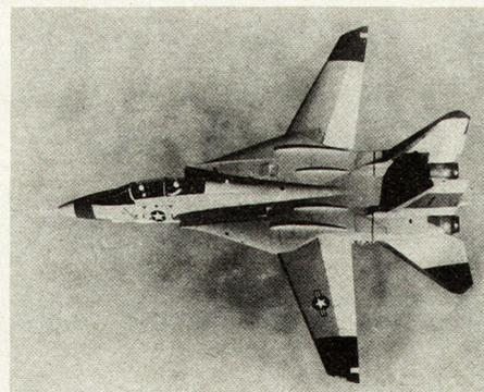
Bild 2. Der im Flug sichtbare Prototyp des F-14-A, X-1 der inzwischen bei der Flugerprobung verlorengegangen, mit Tragwerk für Start- und Landekonfiguration voll gespreizt.
