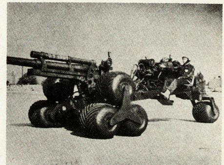
Sumpf oder anderes schwieriges Gelände fortbewegen kann. Die Ausrüstung besteht aus einem normalen Motor in Verbindung mit einem hydrostatischen Antrieb, die Handhabung erfolgt mit Hilfe eines Steuerknüppels. Die für den Lufttransport gedachte Waffe läßt sich mit Bedienung und Munition von einem Helikopter CH 47 «Chinook» transportieren. bb
