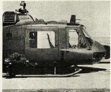
erhebungen; ferner besitzt das System einen Funkhöhenmesser und ein mit dem Radar gekoppeltes Minigun. Das Rotorblattradar fungiert als Abstradar und kennzeichnet Uferlinien und Gelände. Es soll vor allem den Nacht- und Schlechtwettereinsatz des Hubschraubers ermöglichen. gg
