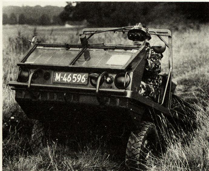
Bild 7. Infrarotrüstung.
