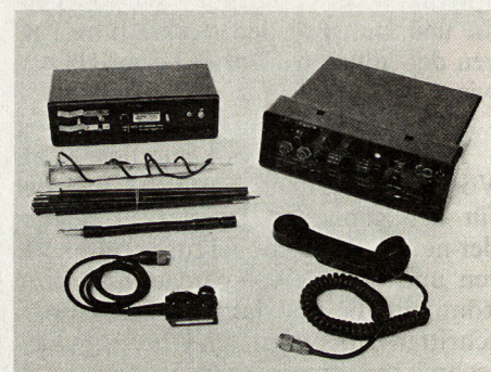
Fig. 10. Tornisterfunkgerät SE-226 mit abgetrenntem Akkumulator und Zubehör
