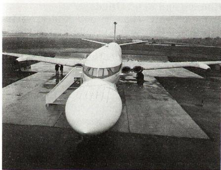
Die ursprüngliche Rumpfform ist gut zu erkennen, und ihr angebaut ist der riesige Unterteil mit der Radomspitze. Die «Nimrod» erreicht eine Reisegeschwindigkeit von 900 km/h und wird von 4 Doppelstromtriebwerken Rolls-Royce RB 168 «Spey» Mk. 250 mit je 5300 kp Schub angetrieben. Besatzung 3 Mann zusätzlich 12 Spezialisten an Bord. Kg.
