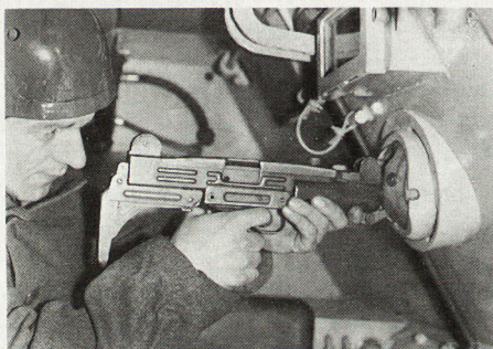
Bild 2. Weltweit patentierte Mowag-Kugelblende in geöffnetem Zustand mit eingesetzter Maschinenpistole.
