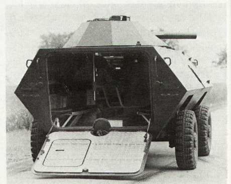
Bild 3. Blick in den geräumigen Kampfraum der «Piranha» 4×4. Hier in der Mehrzweckausführung als Panzeratruppe, Markier-, Ambulanz- und Transportfahrzeug mit großer Heckklappe.
