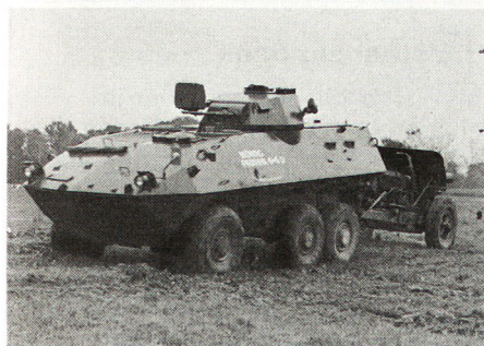
Bild 5. Eine weitere der zahlreichen Einsatzmöglichkeiten der Mowag «Piranha»: als Zugfahrzeug für Kanonen, wobei die Bereitschaftsmunition geschützt im Panzerfahrzeug mitgeführt wird.
