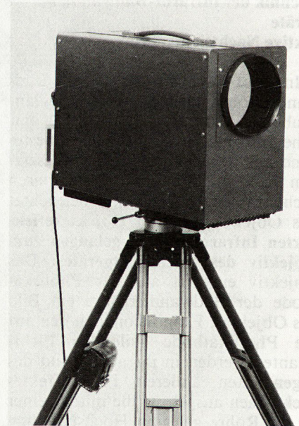
Bild 4. Wärmebildgerät (WBG 2) mit einer Temperaturauflösung von 0,1° K.
